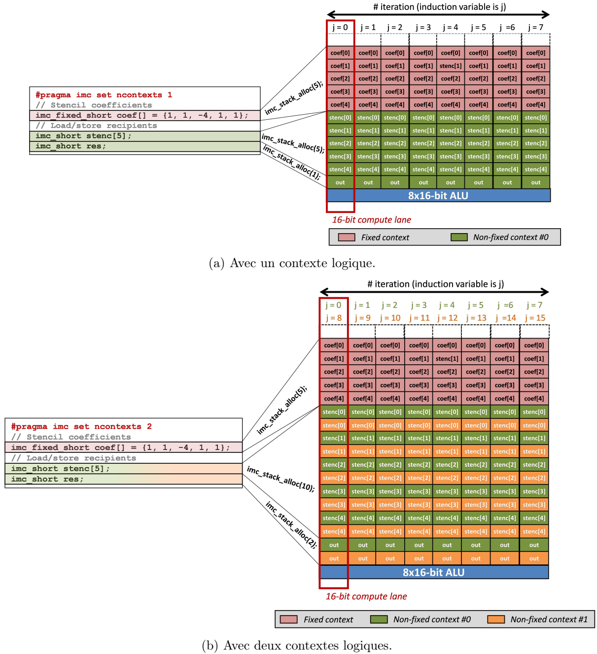
FIGURE 5.3 – Les clauses de déclarations de variables IMC peuvent être paramétrées avec des directives imc pour augmenter la taille des zones mémoires C-SRAM associées à ces dernières.
